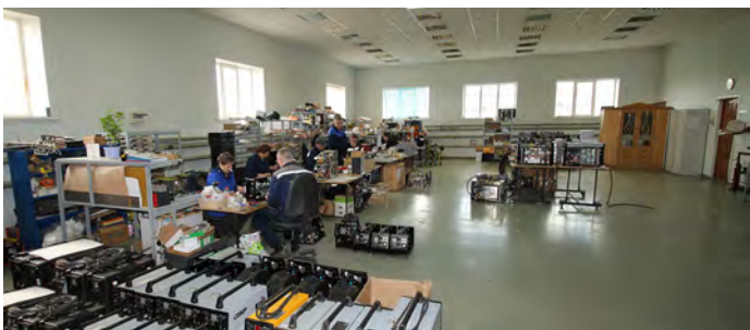
Участок сборки инверторных источников
