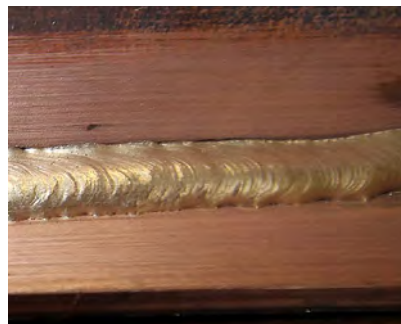
Сварка медных пластин встык в нижнем положении медно-алюминиевой проволокой CuAl8 диаметром 1,2мм в импульсном режиме.
