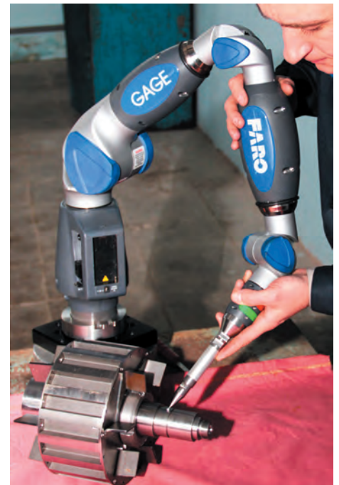
Координатно-измерительная электронная установка для измерения угла и диаметра конуса вала генератора
