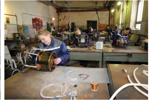
Укладка обмоток сварочных генераторов
