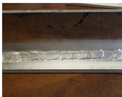
Сварка таврового соединения сплава алюминия с магнием АМг61 сплошной проволокой ESAB OK Autrod 18.22 диаметром 1,2мм в импульсном режиме.
