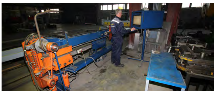
Трубогибочный станок с ЧПУ для изготовления каркасов и рам малогабаритных агрегатов
