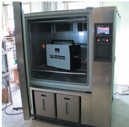
Климатическая камера для испытания инверторных источников и блоков управления агрегатов
