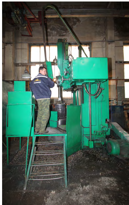
Токарно-карусельный станок для мех. обработки внутренней поверхности станин генераторов серии ГД
