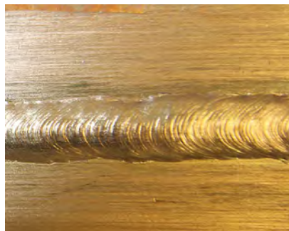
Сварка бронзовых пластин встык в нижнем положении проволокой CuAl8 диаметром 1,0мм.
