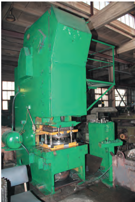
250 тонный механический пресс для вырубki листов статора
